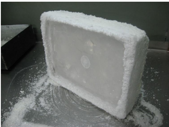
Рис. 3. Кристал \text{NaI(Tl)} , покритий гарнісажним шаром після вилучення з тигля.
