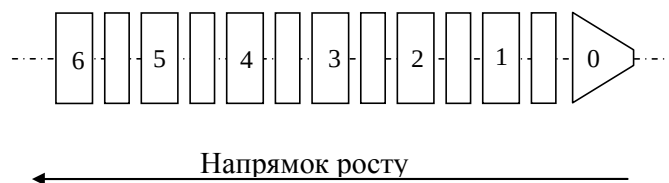
Рис. 7. Схема прорізки монокристалів, що відповідає номерам зразків.
